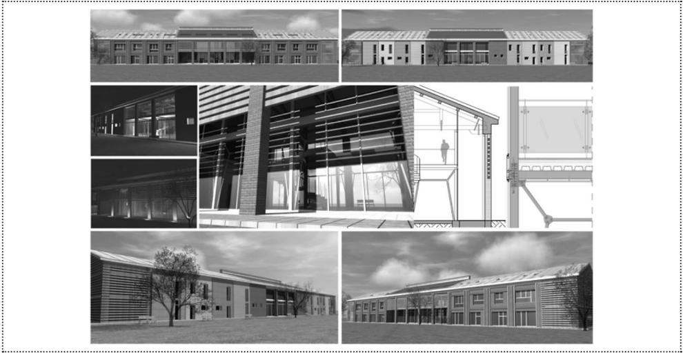
**Figura 1 - Edificio militare nel comparto Sani. Il progetto prevede il recupero delle campate centrali con l'interposizione di una galleria (serra-atrio) a funzione collettiva. Nelle partizioni di testata sono previste nuove unità abitative**
